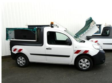
L'adaptation du système GNV peut se faire aussi bien sur une base utilitaire, VP 5 places, pick-up et pick-up avec benne basculante Durisotti
