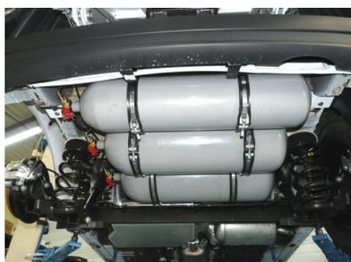
Grâce à l'intégration des réservoirs sous plancher, le volume du coffre reste identique à celui d'une version diesel ou essence.
