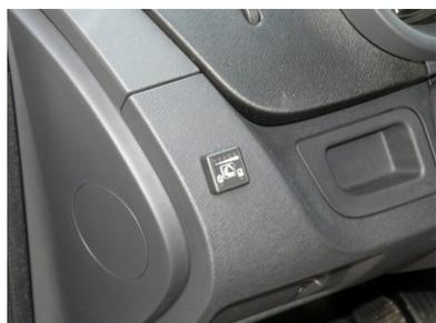
Un simple bouton sur le tableau de bord vous permet de choisir de rouler au GNV ou à l'essence. Plus de gaz dans les réservoirs, le véhicule rebascule automatiquement en mode essence.
